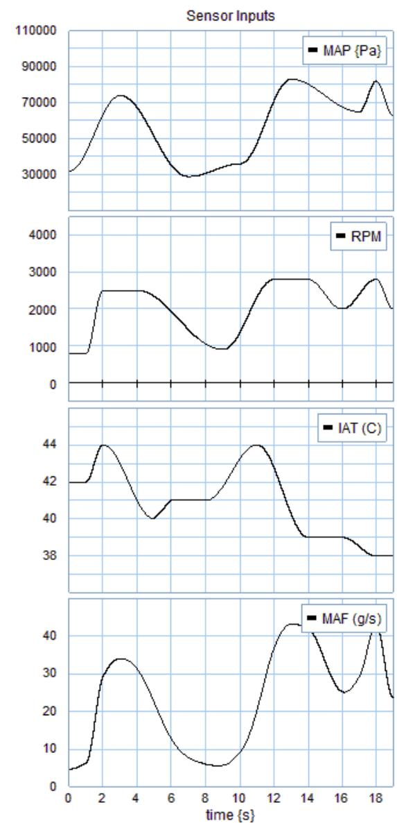
Fig. 12 Sensor Inputs
